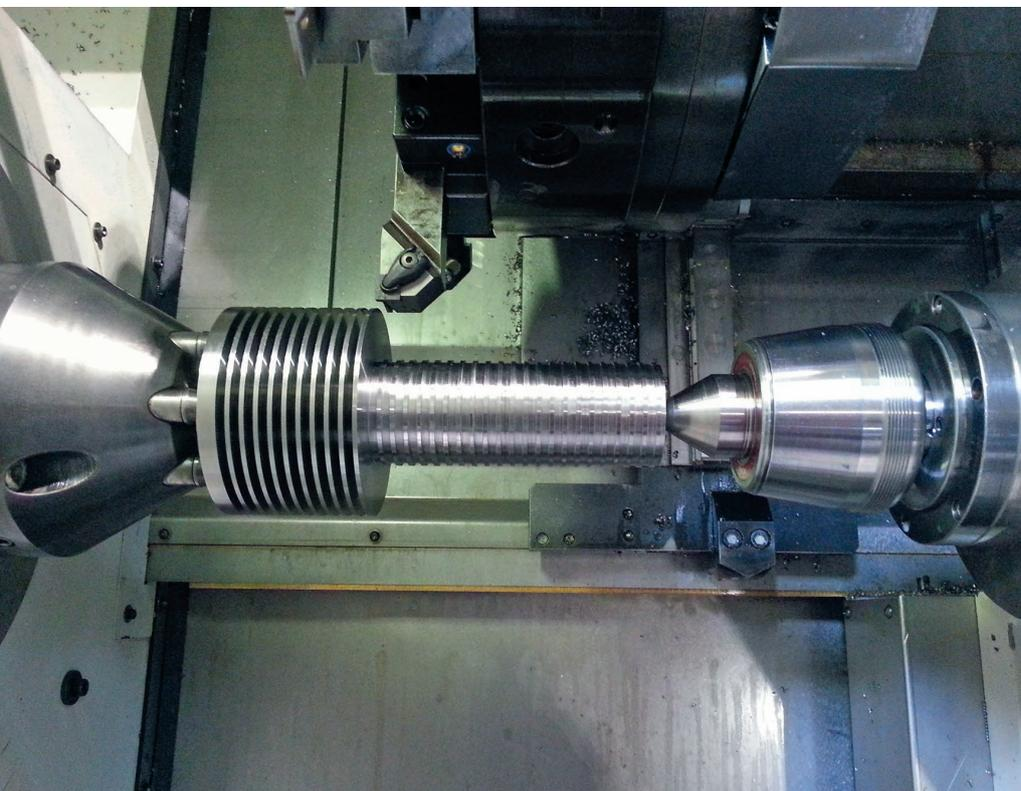
1 Versuchsaufbau zur Aufnahme des Verschleißes verrundeter Werkzeuge. Das Einsatzverhalten von Hartmetallwerkzeugen kann durch angepasste Schneidkantenverrundung optimiert werden (© IFW)
